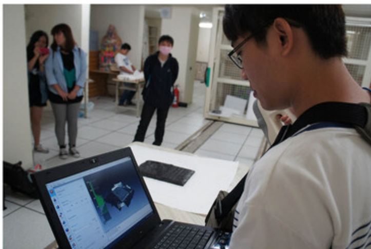
圖：使用3D手持式掃描器掃描文物並同步於電腦成形
